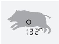
В режиме сканирования происходит постоянное измерение расстояния до движущихся целей. Режим сканирования включает автоматически, если держать нажатой кнопку измерения более трех секунд.
