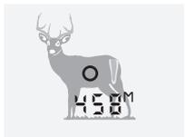
Прицельная марка появляется при кратковременном нажатии на кнопку измерения. Отпустив кнопку, на дисплее можно увидеть измеренное расстояние. Для предотвращения чрезмерной нагрузки на глаза выполнение следующего измерения допускается только примерно через две секунды. В это время работы на дисплее отображается серия знаков «минус». Производится измерение.
