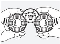
Для настройки резкости изображения объекта с кратчайшего расстояния фокусировки (см. Technical Data Sheet) до бесконечности, просто поверните фокусирующее колесо.
