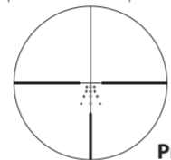
Усовершенствованная визирная сетка BDC
