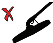
Неверный угол поисковой катушки к земле
