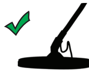
Правильный угол поисковой катушки к земле
