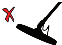
Неверный угол поисковой катушки к земле
