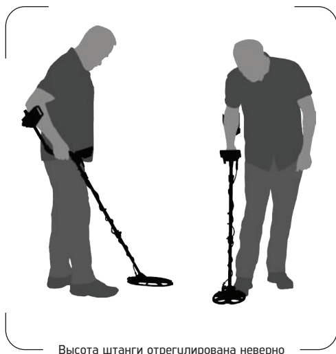
Высота штанги отрегулирована неверно
